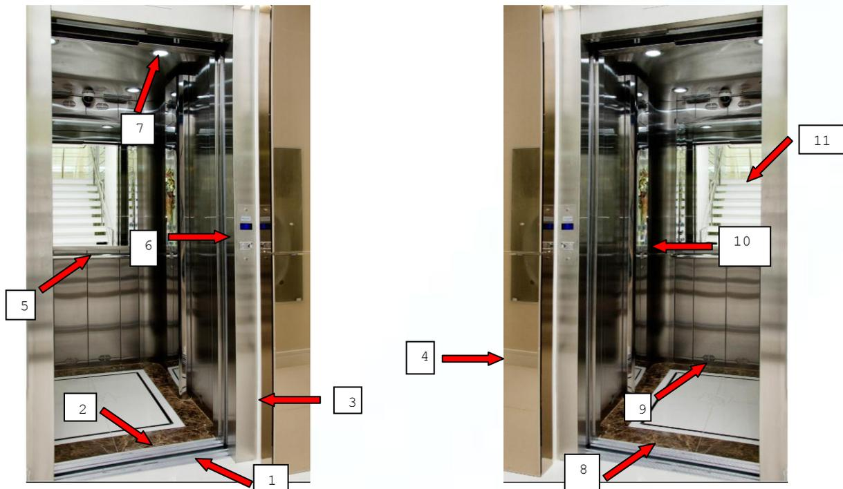
**Figuras 23 e 24** – Vista Panorâmica de uma Cabina com Painéis (Paredes) em Aço Inox Escovado, Justapostos na posição Vertical, com Espelho e Corrimão ao fundo na metade superior (Opcional – espelho na parede inteira ou em mais lados).
