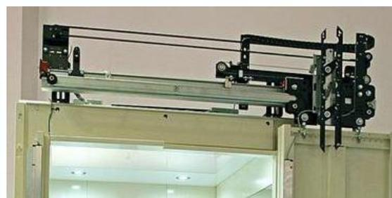
**Figuras 44 e 45 – Operador de Portas e Conjunto do Operador de Portas e Portas de Cabina.**
