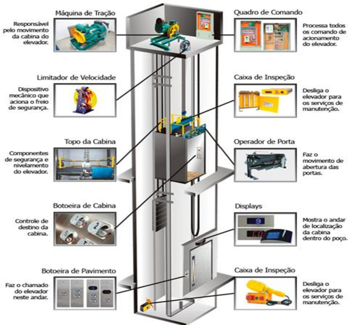
Figura 2 - Vista Explodida de um Elevador Elétrico e os seus respectivos Sistemas de Movimentação e Controle.
