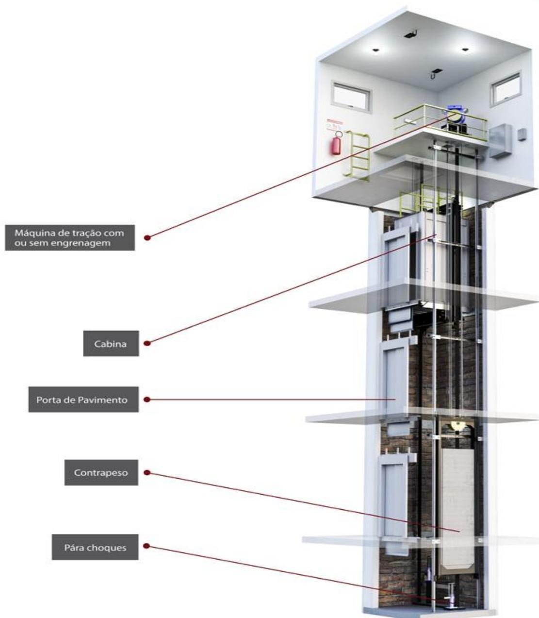
**Figura 1** - Vista Fantasma do Esquema Geral de Instalação de um Elevador Elétrico com Casa de Máquinas mostrando a Máquina de Tração e o Quadro de Comando na Casa de Máquinas, a Cabina e o Contrapeso dentro da Caixa de Corrida, as Portas de Pavimento e Fundo do Poço.
