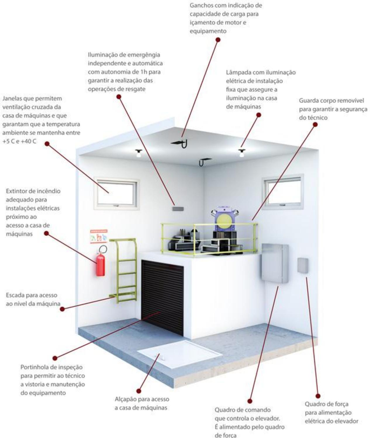
**Figura 3** – Casa de Máquinas com a presença de Quadro de Comando, Máquina de Tração e Regulador de Velocidade.
