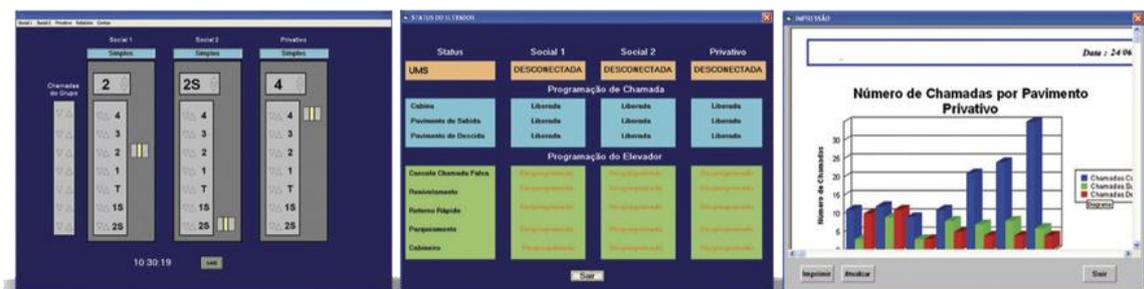
Figura 20 - Software que permite o monitoramento dos elevadores à distância.
