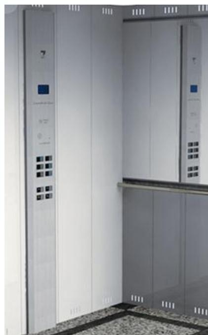
**Figura 8** – Exemplo de uma Cabina com Painéis em Aço Carbono com Pintura Epóxi, Justapostos na Vertical, Espelho ao Fundo na metade superior, com Corrimão Retangular de composição mista, POC de cabina Plano em Aço Inox Escovado instalado na lateral da cabina, Sub Teto em Aço Inox Escovado com Acrílico e Rodapés em Aço.
