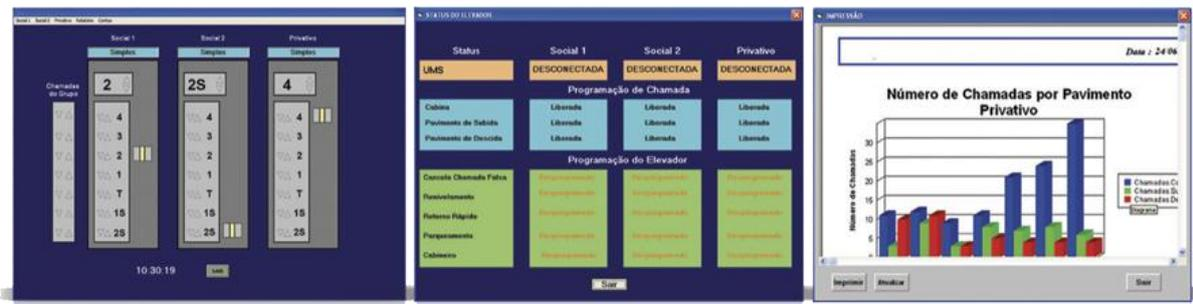
Figura 59 - Software que permite o monitoramento dos elevadores à distância.
