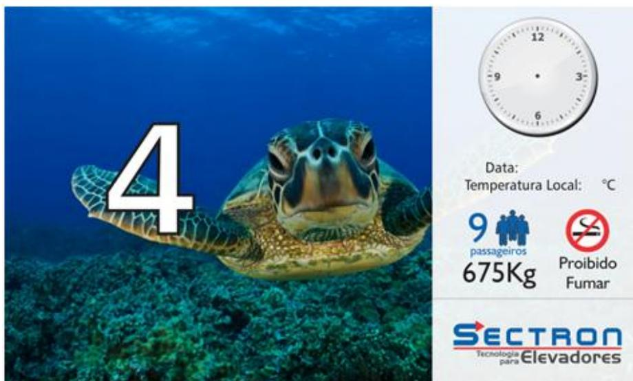
**Figura 39 – IPD (Indicador de Posição Digital) com tela de LCD (Display de Cristal Líquido) - Multimídia com possibilidade de programação do conteúdo (setas animadas, posição do elevador, informação da capacidade de carga da cabina, relógio, calendário, marcador de temperatura interna e seta direcional de indicação do movimento), disponíveis nos tamanhos 3.5”, 4.4” e 7” (polegadas).**
