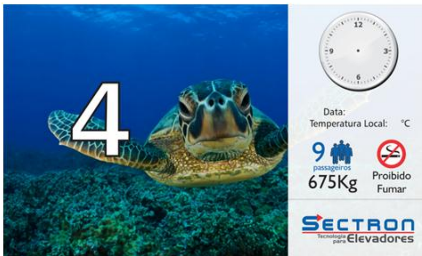
Figura 38 – IPD (Indicador de Posição Digital) com tela de LCD (Display de Cristal Líquido) - Multimídia com possibilidade de programação do conteúdo (setas animadas, posição do elevador, informação da capacidade de carga da cabina, relógio, calendário, marcador de temperatura interna e seta direcional de indicação do movimento), disponíveis nos tamanhos 3.5", 4.4" e 7" (polegadas).
