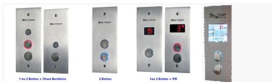
Figura 36 – Botoeiras de Pavimento disponíveis em diversos modelos sem e com IPD e Seta Direcional nos tamanhos de 20 mm e com LCD em 3 polegadas em Aço Inox Escovado.
