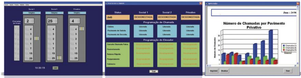
Figura 20 - Software que permite o monitoramento dos elevadores à distância.
