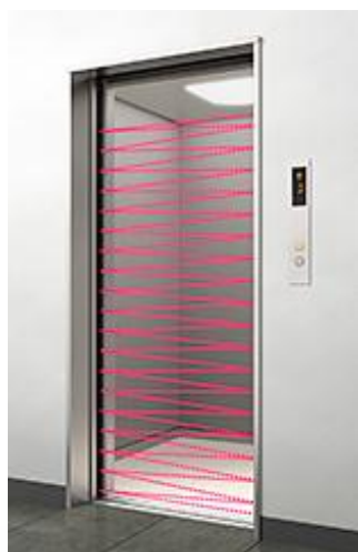
Figuras 51 e 52 - Imagem ilustrativa do Feixe de Luz Invisível (sensor com raios infravermelhos) para reversão do fechamento de porta e régua emissora e receptora da fotocélula. (Utilizado somente em Portas Automáticas).
