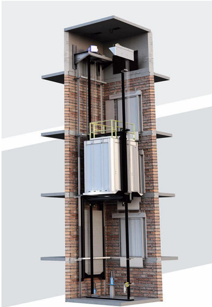
Figura 1 - Vista Fantasma do Esquema Geral de Instalação de um Elevador Elétrico Sem Casa de Máquinas mostrando a Máquina de Tração dentro da Caixa de Corrida, a Cabina, o Contrapeso, Portas de Pavimento e Cabina e o Fundo do Poço.
