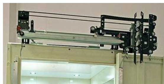
Figuras 44 e 45 – Operador de Portas e Conjunto do Operador de Portas e Portas de Cabina.
