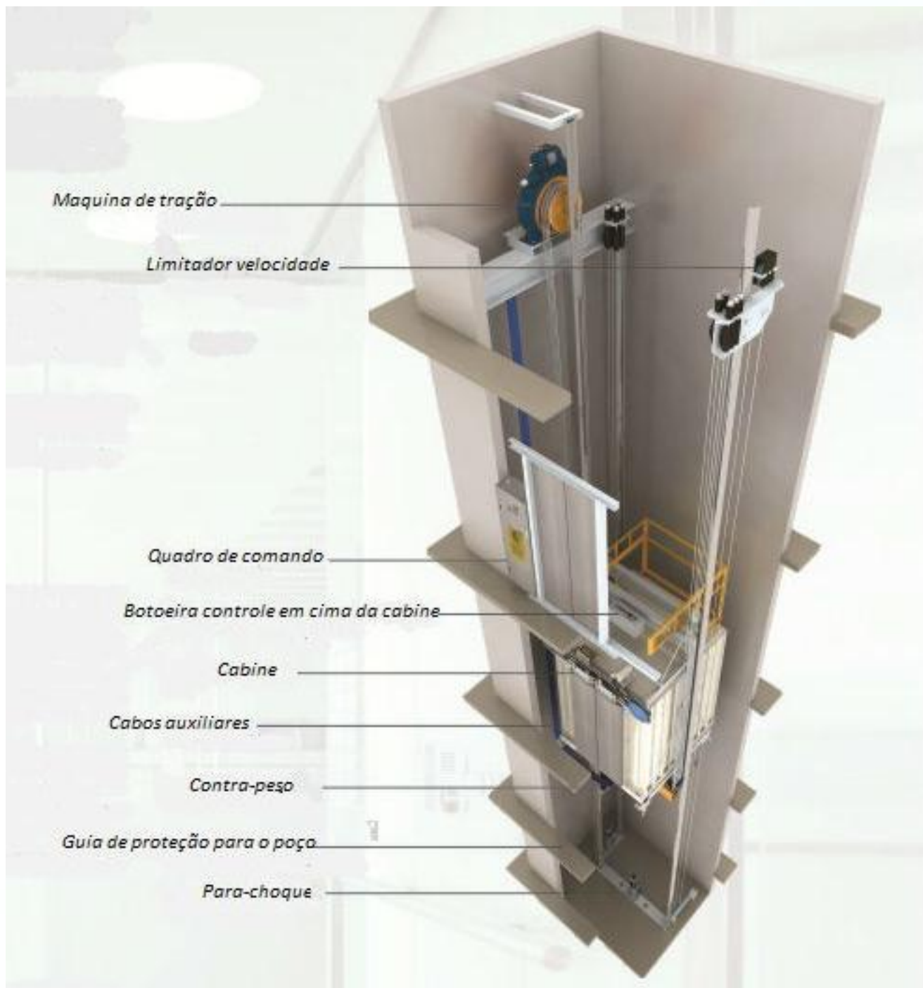
Figura 2 - Vista Fantasma de um Elevador Elétrico Sem C.M. e os seus respectivos Sistemas de Movimentação e Controle.
