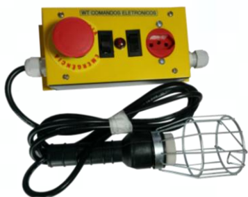
Figuras 14, 15 e 16 – Caixa PAP (Chave de Emergência do Fundo do Poço), Sensor de Posição e Limites de Fim de Curso respectivamente.
