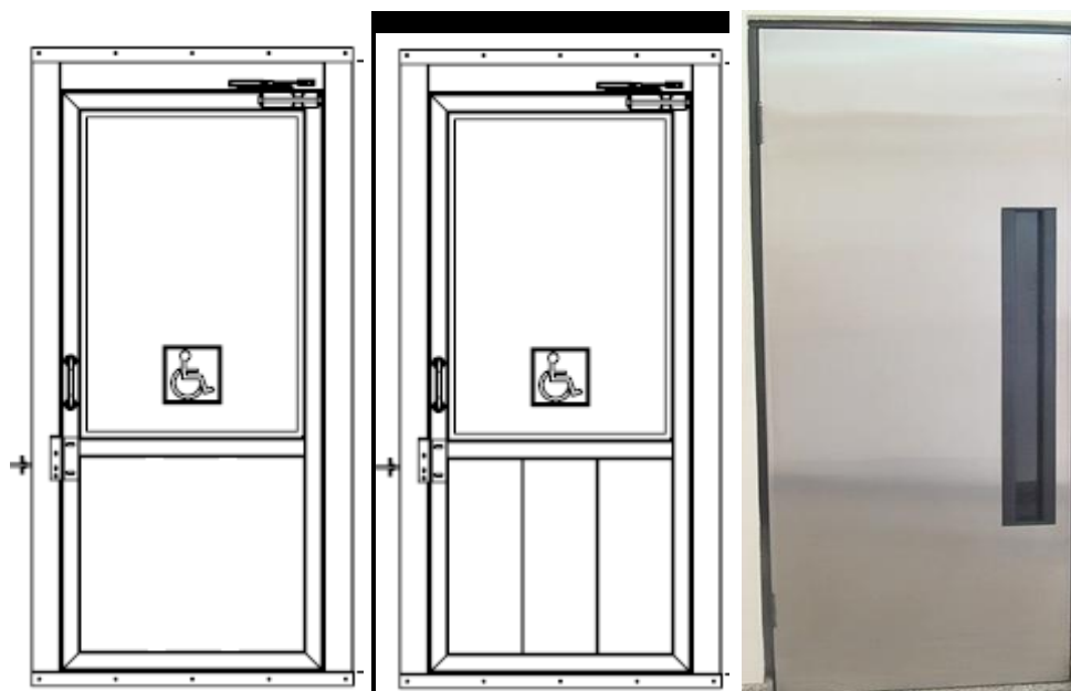
Portas com 2 (duas) aberturas de Vidro, com uma Abertura de Vidro e Portas de Aço apenas com o Visor de Vidro.
